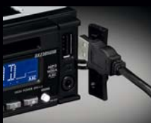
携帯オーディオやUSBメモリー収録のMP3/WMA/AACファイル再生にも対応したフロントUSBスロット
