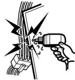
車体に穴を開けて取り付ける際は、パイプ類・タンク・電気配線などの位置を確認のうえ、これらと当たったり接触することがないようにしてください。火災の原因になります。
