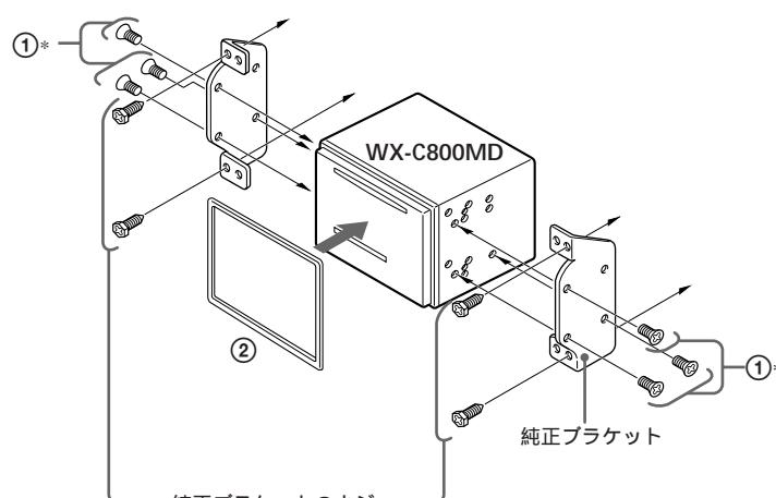
\* 付属の皿ネジ①で取り付けてください。他のネジを使わないでください。故障の原因となります。
