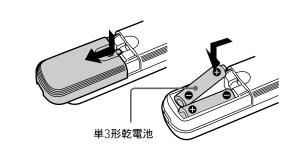
電池の交換時期は約6か月です。リモコン操作できる距離が短くなった ら、2個とも新しい乾電池に交換してください。
